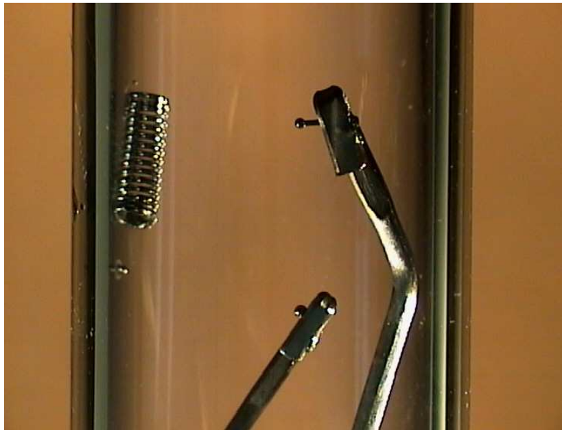
Simulace v laboratoři OSRAM (přepětí 24V)
